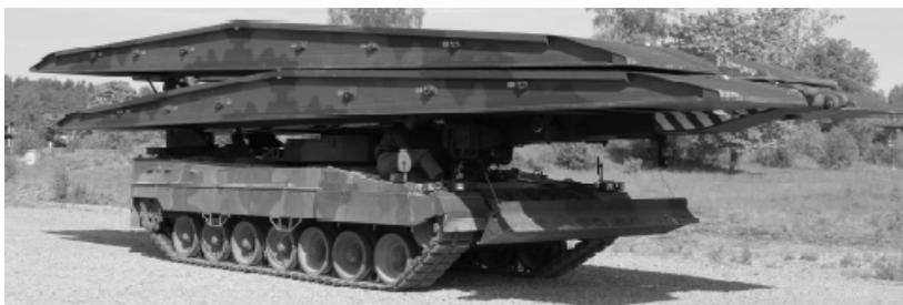
Sistema posaponti con assortimento di ponte  $2 \times 14$  metri
