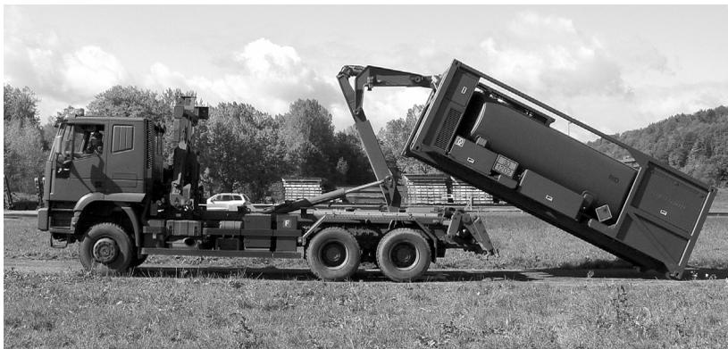
Scarico dall'autocarro Iveco 6×6
