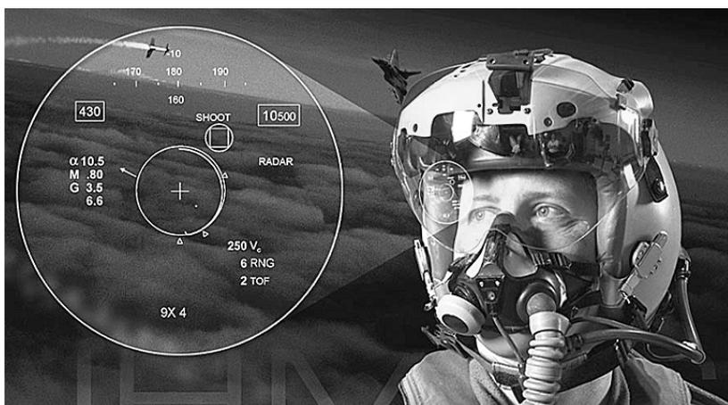
Grazie al sistema di puntamento incorporato nel casco, il pilota dirige il missile con i movimenti del capo.
