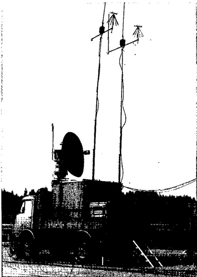
Übermittlungsterminal für Flugführung, Bildsignalempfang und Sprechfunkübertragung
