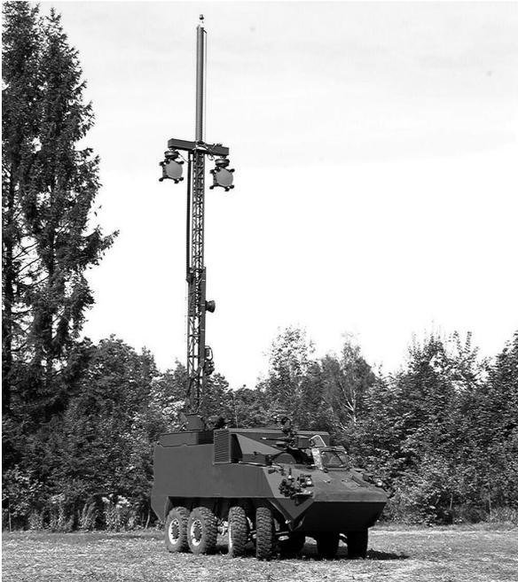
RAP Pz mit integriertem Mast, fix montierten Antennen und Richtstrahlgeräten.
