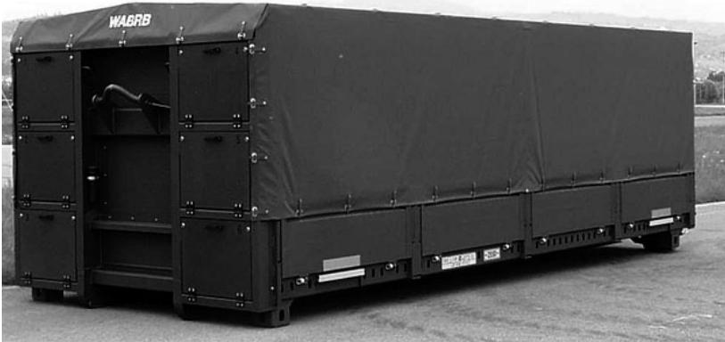
Die Abrollbehälter sind als Universalbehälter konstruiert. Für spezielle Transporteinheiten (zum Beispiel Munition) können sie mit verschiedenen, zusätzlichen Transportmodulen bestückt werden.
