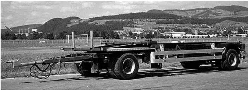
Die Anhänger bilden mit den bereits im Rahmen des Rüstungsprogrammes 1999 eingeführten Anhängern eine Familie von luftgefederten 2-achsigen Anhängern. Mit ihnen können Wechselbehälter ohne Hilfsmittel ab Stützen aufgenommen und wieder abgestellt werden. Mittels Schlitten können in Kombination mit den Lastwagen die Abrollbehälter und Container ab Boden aufgeladen und wieder auf den Boden abgestellt werden.
